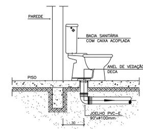
OBS: O FLURO DO VASO DEVERÁ SER LOCADO A 0,30m DA PAREDE PRONTA
