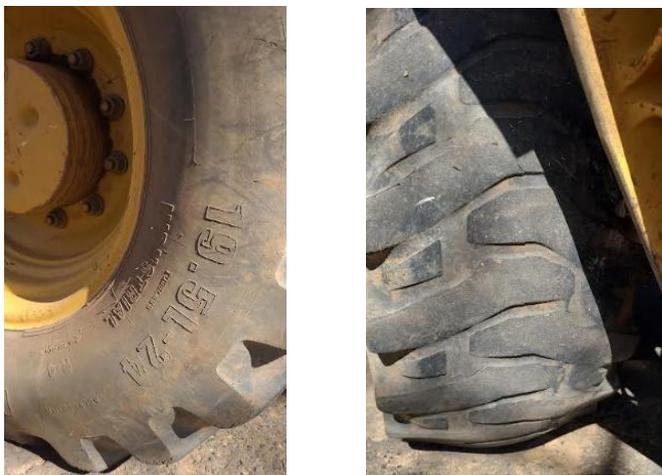
**5.6.** Ressolagem com banda pré-moldada ou processo a quente, conforme especificação técnica pneu traseiro para o caminhão M. BENZ/L 1318, ANO 2010, PLACA BNZ9G39, CHASSI: 9B3694000AB723792.
