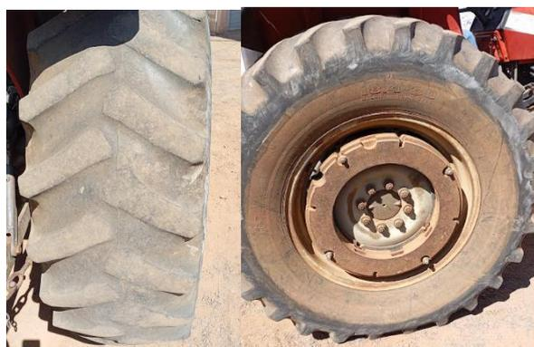
**5.8.** Ressolagem com banda pré-moldada ou processo a quente, conforme especificação técnica pneu traseiro para Valmet 65ID.
